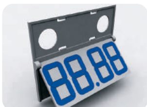
Zglobni modul PP30 sa 4 cifre (2 decimale) i dodatnim prostorom za postavljanje štampe. Visina cifara: 30 mm. Ukupne dimenzije: 66x80 mm. Dimenzije printa: 24x77 mm Zglobna osnova je uključena i moguće je pričvrstiti je samolepljivom trakom (nije uključena), zavrtnjima ili CLEAR GRIP dodacima.
